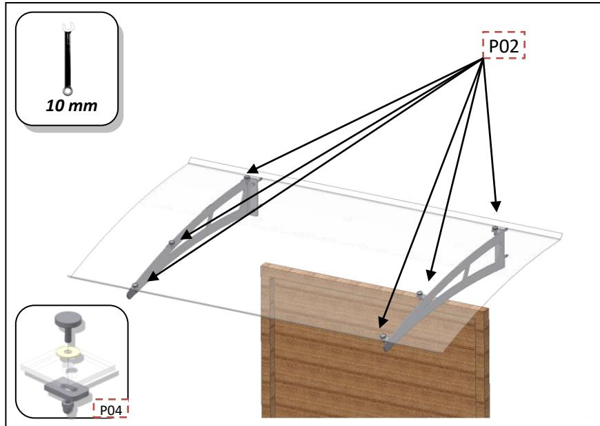
**DK:** Læg derefter 2 mm polycarbonat pladen op og monterer derefter de medfølgende M6x10 mm(P04) møtrikker/bolte. Skiven skal ligge oven på pladen, spænd efter med 10 mm nøgle.
