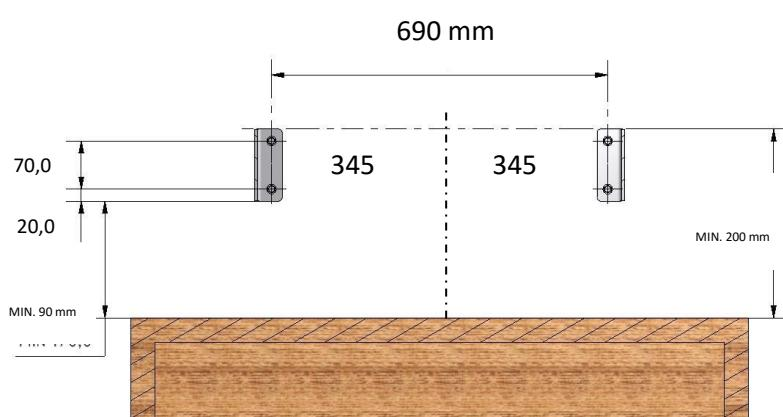
**DK:** Opmål først center punktet af området hvor udhængen skal hænge. Derefter mål min. 200 mm op. Hvor fra en vandret linje opmarkes i længden A eller C. Se ud fra skemaet. Placer derefter knægten(P07) med den vandrette linje til overkant knægt, samt den lodrette linje centret i knægtes huller.(for at sikre en helt lodret knægt kan en lodstok holdes på siden). Marker derefter hullerne i knægten med en tusch.
