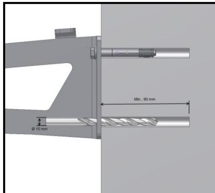
**DK:** Bor derefter hullerne op med et Ø10 mm mur bor, til medfølgende ekspansions bolte (P05). Min. 90 mm. Boltene til fastgørelse kan kun bruges til beton og massive murstens vægge. Hvis udhængen skal hænges op på andet underlag skal andet bæfestigelse anskaffes.
