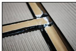
**NL:** Vervolgens neemt u de frame (P06) en neemt van de tape verstevigd (beschermer) uit, wees voorzichtig, doe het langzaam. Zet dan de polycarbonaat plaat naar beneden in het frame. Gelieve juiste plaatsing alvorens de tape beschermer film af. Verzekeren dat de gaten zijn over elkaar. Een siliconen lijn kan in worden gezet om extra bescherming te verzekeren.
