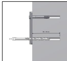
**NL:** Boor vervolgens de gaten met een Ø10 mm muur boren, want de meegeleverde uitbreiding bouten (P05), een minimum van 90 mm. De bouten kan alleen gebruikt worden voor beton en massieve bakstenen muren. Als de luifel moet worden gemonteerd op een andere ondergrond een ander beslag moet worden aangeschaft
